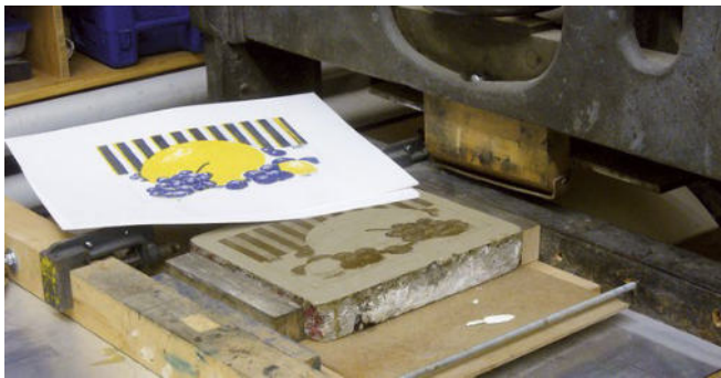
Steindruckplatte mit Abdruck und Reiberpresse
