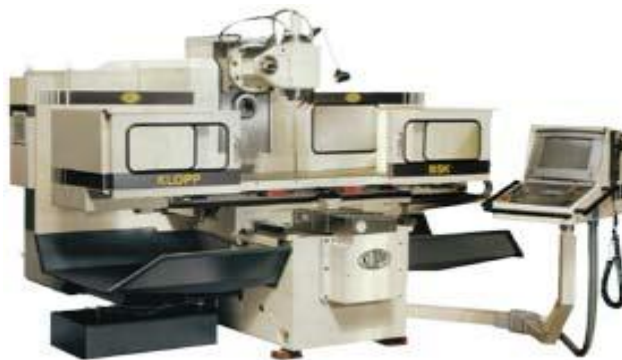
Klopp Fräsmaschine Typ BSK, Gewicht 5,5 t
